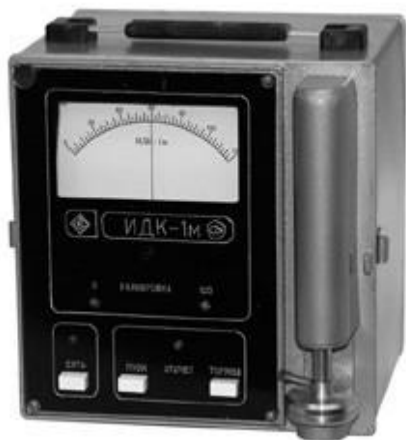
Рис. 6. Прилад для вимірювання індексу деформації клейковини «ВДК-1»
