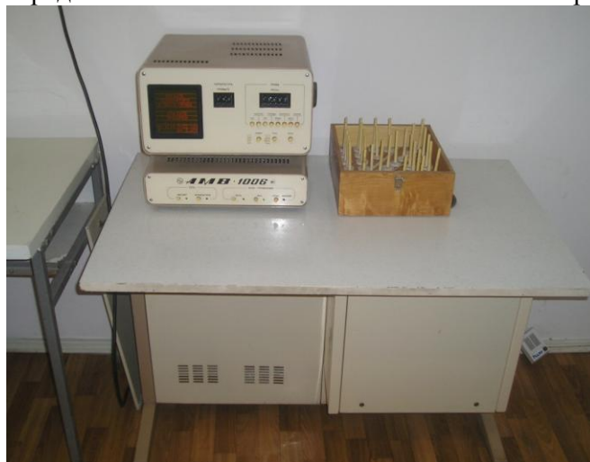
Рис. 17. Загальний вигляд лабораторного ЯМР-аналізатора «АМВ-1006»
